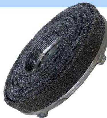
Щетка проволочная дисковая Dвн100 мм\_n1150 об/мин\_Dн380 мм для удаления окалины с поверхности катанки. Тип: торцевая металлическая, наружный диаметр 380 мм, внутренний диаметр 100 мм, материал: проволока стальная, диаметр 0,3 мм. Характеристики: щетка предназначена для тонкой очистки катанки от остатков окалины после ее обработки в окатиноломателе волочильного стана MEKOSAN.
