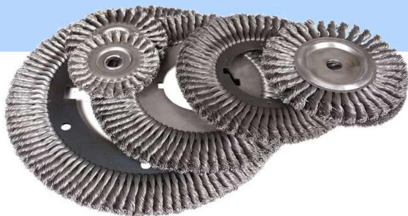
Дисковые витые щетки РВ изготавливаются из пружинной проволоки ГОСТ 9389-75 диаметром 0,6 - 0,8 мм, применяются в ручных углошлифовальных и стационарных машинах для предварительной и завершающей обработок угловых стыковых сварных швов. Широко применяются в металлургии, машиностроении, нефтеперерабатывающей и газовой промышленности. Эффективно очищают окалину, ржавчину, очистка форм после отлива металла, а так же снятие торцевой изоляции.
