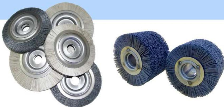
Дисковые полимерно-абразивные щетки РА изготавливаются из полимерно-абразивного волокна с наполнителями SiC и AlO диаметром 0,5 - 1,5 мм. Абразивные щетки применяются в различных отраслях промышленности (удаление легкой ржавчины, черновое шлифование грунтовок, удаление заусенцев с уплотняющих поверхностей), мебельная промышленность (шлифование деревянной мебели и панелей, браширование поверхностей, шлифовка фанеры).
